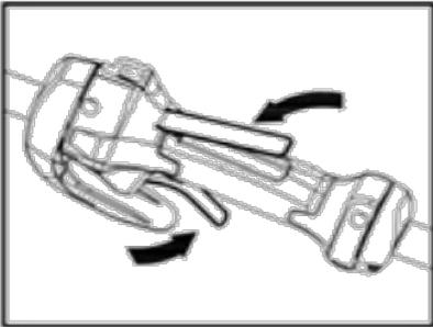
Vérifiez que la commande des gaz et le blocage des gaz bougent librement et que les ressorts de rappel fonctionnent correctement.
