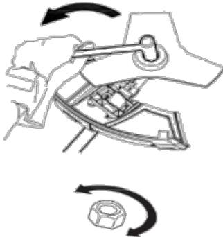
Un écrou de blocage est utilisé pour fixer certains types d'accessoires de coupe. Lors du montage, serrer l'écrou dans le sens inverse du sens de rotation de l'accessoire de coupe. Pour le retirer, dévisser l'écrou dans le même sens de rotation de l'accessoire de coupe. (**ATTENTION !** L'écrou a un filetage à gauche.) Serrez l'écrou à l'aide de la clé à bougie livrée avec la machine ou d'une clé à douille.
