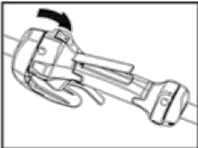
Appuyez sur le côté "O" de l'interrupteur du moteur pour arrêter le moteur. Démarrez le moteur et assurez-vous que le moteur s'arrête lorsque vous mettez le commutateur du moteur en position d'arrêt.
