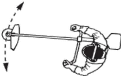
L'effet ventilateur du fil nylon peut être utilisé pour un nettoyage rapide et facile. Tenez le fil parallèle et au-dessus de la zone à balayer et déplacez l'outil d'avant en arrière.
