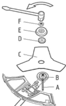
Insérez la tige de verrouillage (A) dans le trou pour verrouiller l'arbre. Placez la lame (C), la plaque de serrage inférieure (D) et le bol glisseur inférieur (E) sur l'arbre de sortie.
