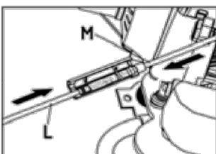
Connectez le câble de fonctionnement (L) et le câble d'accélérateur (M). Fermez ensuite le connecteur du câble d'accélérateur.
