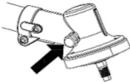
Le renvoi d'angle est rempli de la bonne quantité de graisse en usine. Cependant, avant d'utiliser la machine, vous devez vérifier qu'il est rempli aux trois quarts de graisse.
