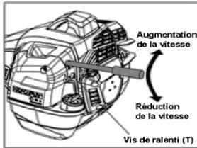
Vérifiez que le filtre à air est propre. Lorsque le régime de ralenti est correct, l'accessoire de coupe ne doit pas tourner. Si un réglage est nécessaire, fermez (tournez dans le sens des aiguilles d'une montre) la vis de réglage du ralenti T, avec le moteur en marche, jusqu'à ce que l'accessoire de coupe commence à tourner. Ouvrir
