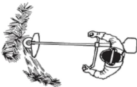
Si la lame est inclinée vers la gauche lors du fauchage de l'herbe, l'herbe s'accumulera en ligne, ce qui facilitera le ramassage, par exemple en ratissant.
