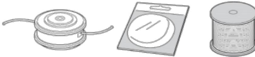
Les petites machines nécessitent généralement de petites têtes de coupe et vice versa. En effet, lors du débroussaillage à l'aide d'une tête fil nylon, le moteur doit éjecter le fil nylon radialement de la tête de coupe et vaincre la résistance de l'herbe à débroussailler.
