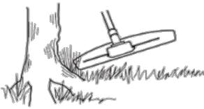
La technique de défrichage élimine toute végétation indésirable. Gardez la tête de coupe juste au-dessus du sol et inclinez-la. Laissez l'extrémité du fil nylon frapper le sol autour des arbres, des poteaux, des statues et autres. **PRUDENCE!** Cette technique augmente l'usure du fil nylon.
