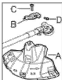
La bavette de protection doit toujours être montée sur le protecteur lors de l'utilisation de la tête fil nylon.
