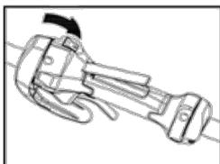
Arrêter le moteur en coupant le contact.
