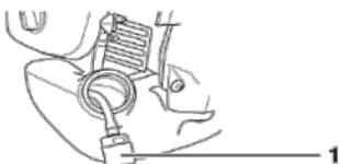
Lorsque le moteur manque d'alimentation en carburant, vérifiez que le bouchon du réservoir et le filtre à carburant ne sont pas bouchés.
