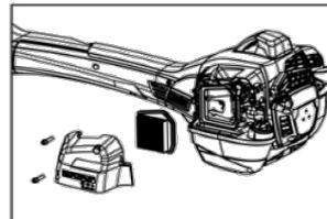
Nettoyez le filtre toutes les 25 heures, ou plus régulièrement si les conditions sont exceptionnellement poussiéreuses. Retirez le couvercle du filtre à air et otez le filtre. Lavez-le dans de l'eau chaude savonneuse. Assurez-vous que le filtre est sec avant de le remettre en place.
