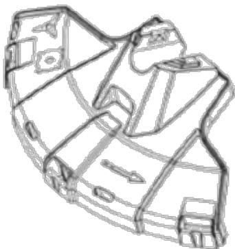
Cette protection est destinée à empêcher la projection d'objets mobiles vers l'opérateur. La protection protège également l'opérateur d'un contact accidentel avec l'accessoire de coupe.
