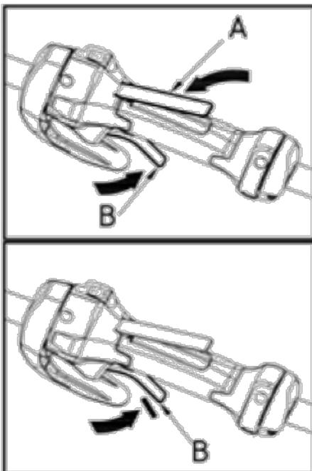
Le verrouillage des gaz est conçu pour empêcher le fonctionnement accidentel de la commande des gaz. Lorsque vous appuyez sur le verrouillage "A" (c'est-à-dire lorsque vous saisissez la poignée), cela libère la gâchette d'accélérateur "B".
